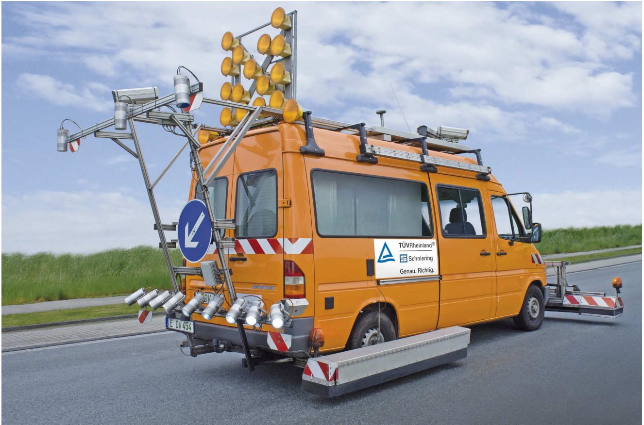
Multifunktionales Messsystem ARGUS® mit Makrovideosystem und Hochleistungsstroboskopen
